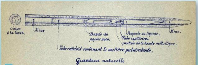
6 Schéma d'un crayon explosif, juillet 1918. Arch. dép. du Loiret, 4 M 14.
